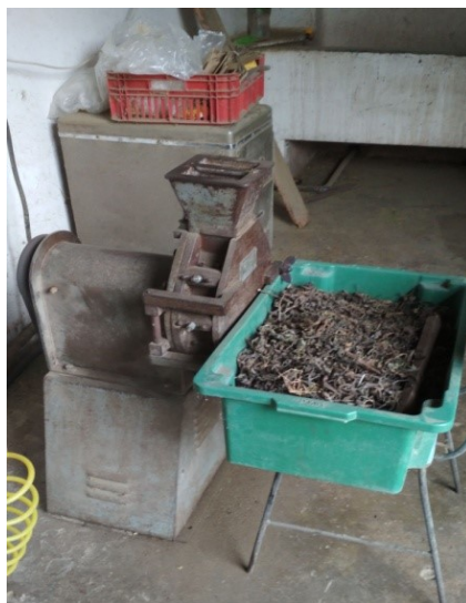
Figura 4. Molino de forraje “Wiley Mill”, modelo standard N°3. Plantas siendo procesadas en molino de forraje.
