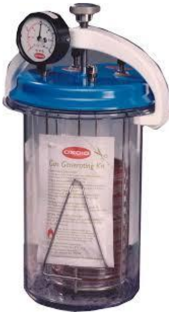
Figura 15: Sistemas generadores de atmósfera. Fuente: http://www.analisisavanzados.com/index.php/anaerobiosis
