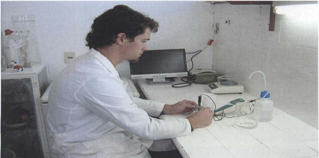
Figura 10. Lectura del pH de las muestras
