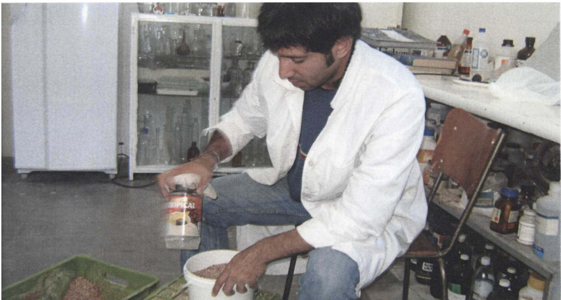
Figura 6. Compactación de los microsilos.
