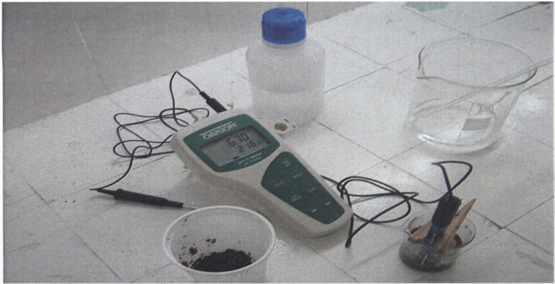
Figura 9. Ph-metro, con vaso de precipitado (abajo a la derecha) y la muestra de microsilo que en ese momento se evaluaba (abajo a la izquierda)
