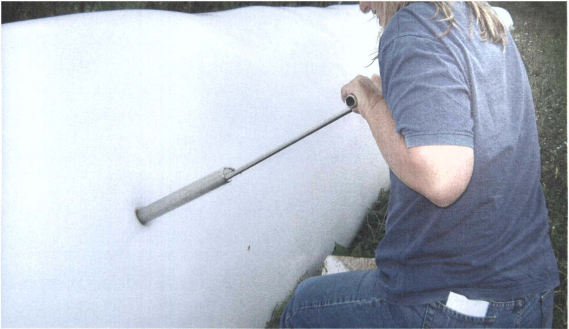
Figura 5. Extracción de las muestras del silo de sorgo con calador.
