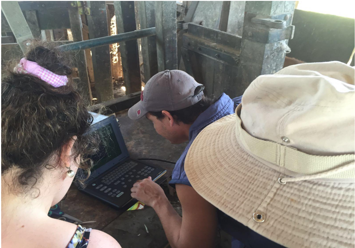
Figura 9. Midiendo el espesor de la grasa en la imagen congelada obtenida con el ecógrafo.
