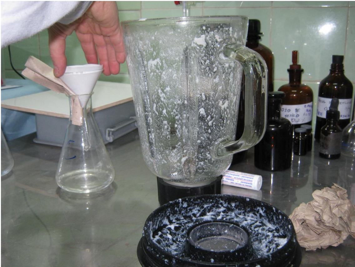
Foto 6 – Licuado y posterior filtrado de la muestra de músculo en ácido tricloroacético (TCA).
