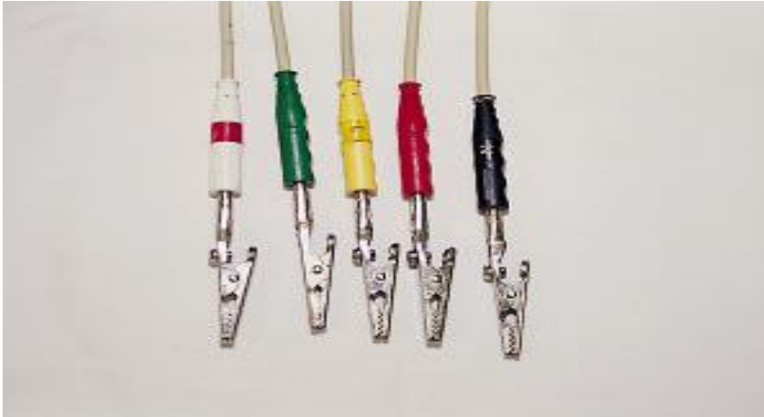
Figura 18. Electrodos unidos a pinzas de cocodrilo. Código internacional de colores (Modificado de Santamarina, 1998).
