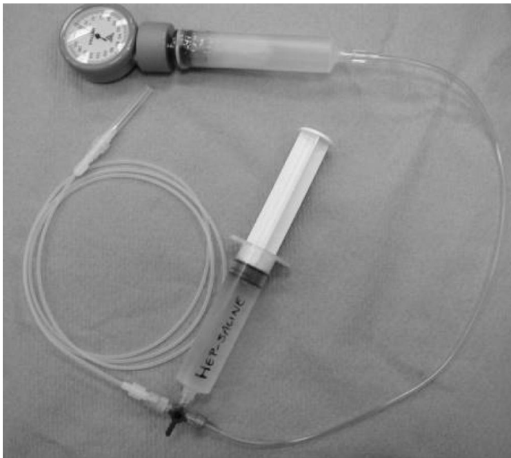
Figura 54. Manómetro aneroide (Modificado de Dugdale, 2010).
