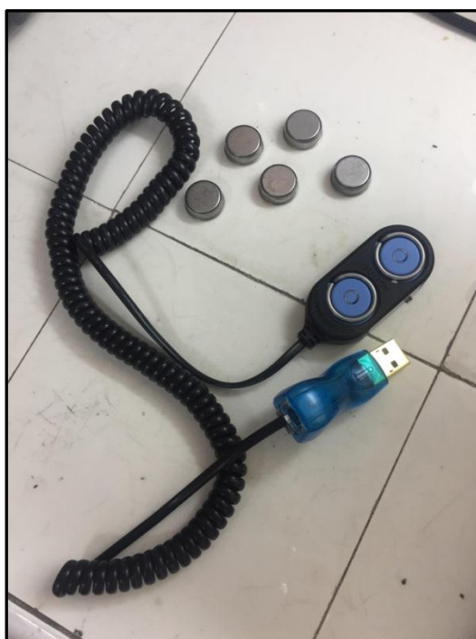
Figura 2. Sensores iButton DS1921H y dispositivo de descarga de información.
